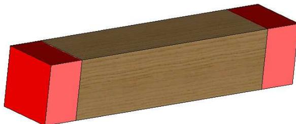
Figure 1 : Carrelet de départ 40x40x200mm
