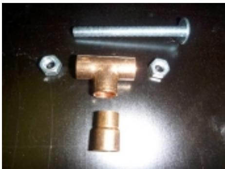
Les taquets de serrage sont réalisés (pour chacun) avec : 2 écrous de 8, 1 boulon poêlier de 8/80, un té en cuivre de 14/14/14, une réduction 12/14. C'est donc à multiplier par le nombre de taquets souhaités (6/8/10/12/16/24, ou autres). Ici c'est une table de 12, donc 24 écrous, 12 boulons, 12 tés, 12 réductions.
