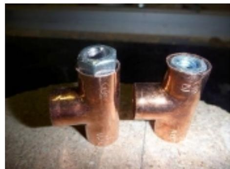
Sur la troisième sortie du té, j'ai ajouté une réduction en cuivre de 12/14, pour allonger ce côté et mieux répartir la force d'appui. J'ai également préféré un simple encollage à la CA, ou époxy, car une soudure aurait recuit le cuivre et celui-ci deviendrait trop souple, donc risque de déformations lors des serrages.
