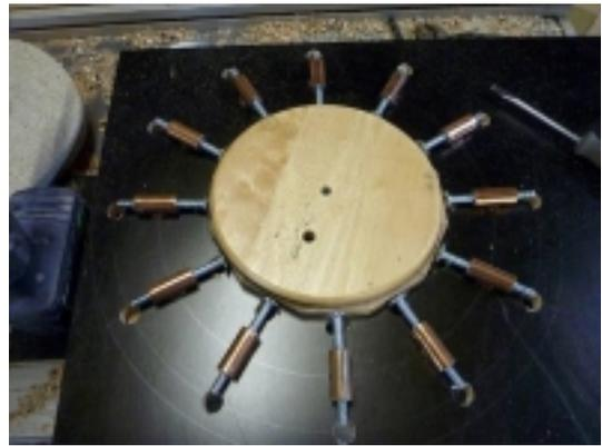
La mise en place des segments étant terminée, un disque est mis en place sur l'ensemble des segments afin de comprimer uniformément l'ensemble et donc d'avoir un cercle plan.
