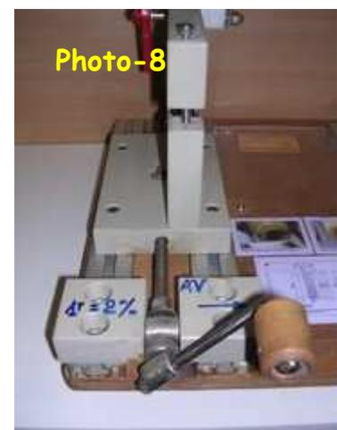
La forme du berceau est fonction de la forme de la défonceuse utilisée ; la petite pièce en rouge (Photo-9) est une came que j'appelle « tête de lapin » et qui sert à la fois de sécurité et de maintien du contact de mise en route de la défonceuse ; la dimension de l'oreille permet une bonne préhension en cas d'urgence pour arrêter l'outil.
