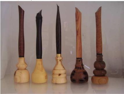
Pour les quatre noirs se sont des roller (panaches). Pour la partie haute, sertir l'extrémité et la meuler au diam du tube ; c'est elle qui bloque le ressort de la cartouche. Pour la base, juste la jonction filetée ; pour celui du milieu c'est pareil sauf que ce n'est pas le même modèle.
