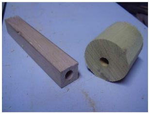
Percer les deux pièces au diam de votre tube et de profondeur égal a la longueur du tube.(trous borgne )
