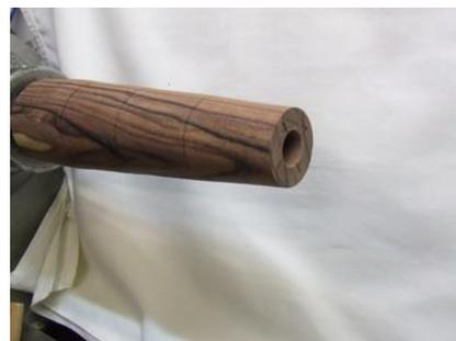
1° décentrage : j'ai, utilisé une tige de 5mm sur un mandrin de perçage
