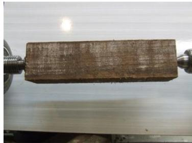
cylindrer le carrelet conique de 55mm à 35mm
