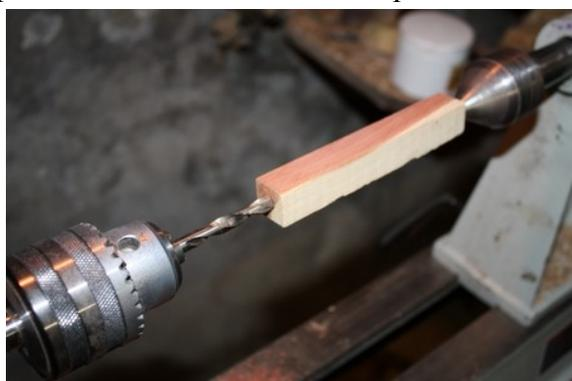
► Le premier tube est collé au fond du carrelet. Les résidus de colle laissés par le passage du tube encollé sont enlevés en repassant le forêt de 7mm. Le deuxième tube n'est pas collé
