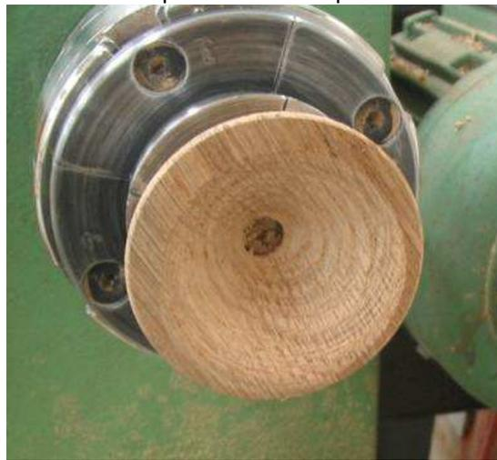
L'épaisseur de la paroi qui subsiste varie entre 3 et 5mm. Inutile de rechercher la finesse, ni la précision rigoureuse. Et même si cela devait vibrer un tantinet ( le maintien sur le tourillon, n'est pas des plus stables) cela importe peu sur le résultat final. Inutile également de poncer à ce stade.
