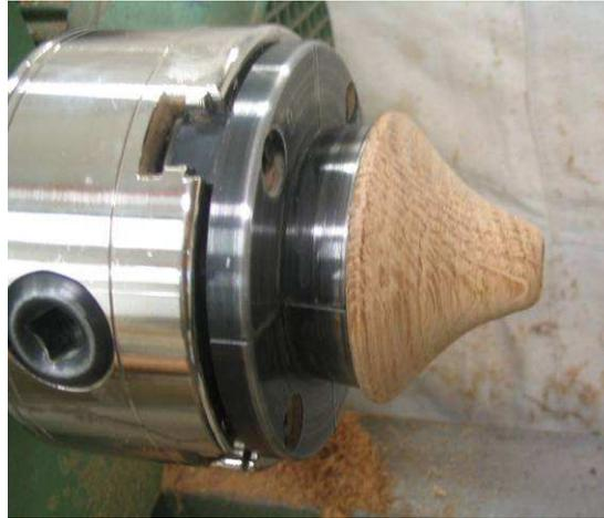
On retourne ensuite la pièce en l'emmanchant sur le même tourillon pour la creuser partiellement (on laisse environ 10mm d'épaisseur vers la pointe de la cloche)
