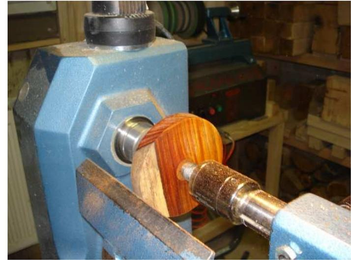
Usinage du couvercle ici en cocobolo
