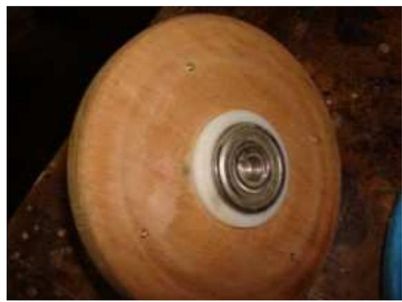
Vous placez l'ensemble cône /roulement entre les deux flaqes et vous serrez l'ensemble à l'aide des vis 4X25 (en raison du petit diamètre du roulement dont je disposais j'ai confectionné une sur cage en ptfe mais c'est facultatif)
