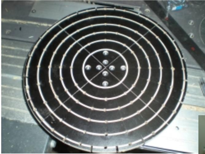
Dans les trous ainsi percés, je place des boulons poêliers avec un arrêt de porte en caoutchouc et un écrou papillon sur l'arrière.
