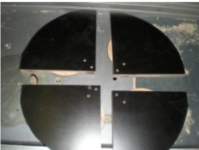
Afin de permettre un bon centrage, j'ai rajouté des lamellos (surtout utiles pour les serrages minimum)
