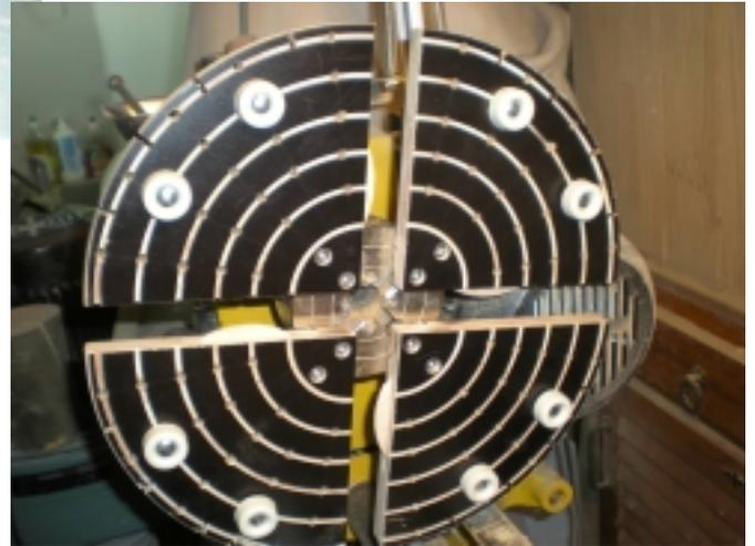
La même chose avec un des disques permettant le maintien de forme non adaptées aux taquets souples. Ils sont réalisés dans du médium de 10 et un chanfrein a été réalisé sur la face en contact avec la pièce. La fixation de l'ensemble est faite avec un fil de fer fin qui serpente entre les différentes encoches.
