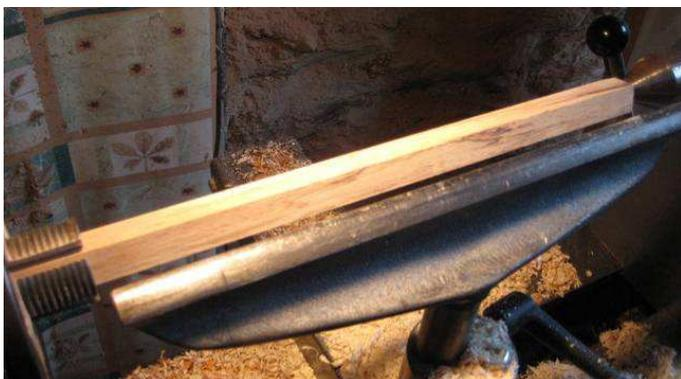
Cylindrage à la plane ovale de 30mm, en soutenant celle-ci à cause de la souplesse due à la finesse
