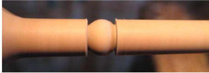
Arrondissement des arêtes aux côtés de la boule au bédane de 5mm, et extrémités au bédane également.
