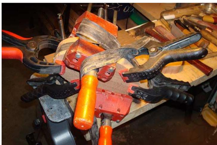
Le collage est bien sec, vous mettez en place vos couvercles (à blanc) et vous faites le ponçage extérieur très soigneusement : soit au disque lapidaire, soit à la ponceuse à bande.
