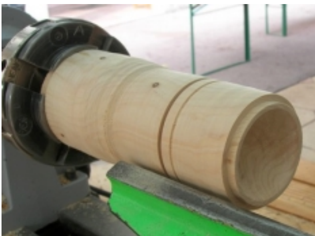
Profiler la feuillure, la courbe extérieure du gland puis le trancher. Il sera terminé en le remontant sur la cupule.
