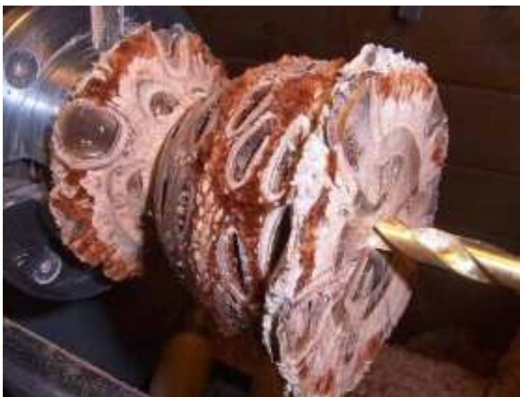
Séparez le couvercle et faire une jauge de profondeur
