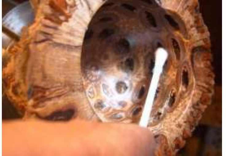
Videz les alvéoles avec une pointe à tracer , poncez jusqu'au 600, finition shellawax ultrashine et shellawax liquide puis videz le surplus des alvéoles avec un coton tige
