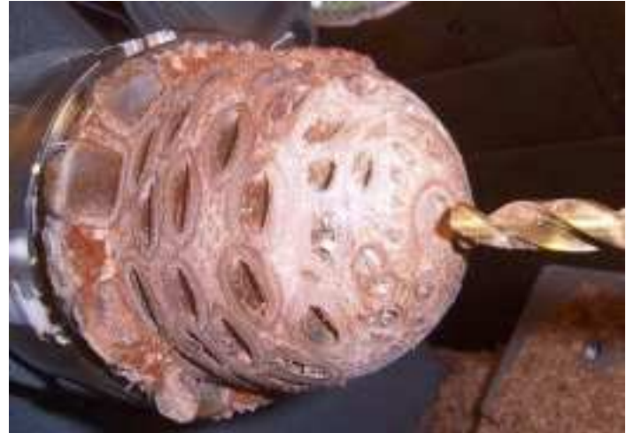
Reprise au mandrin en expansion pour finir l'extérieur (même méthode que pour l'intérieur de la boîte).
