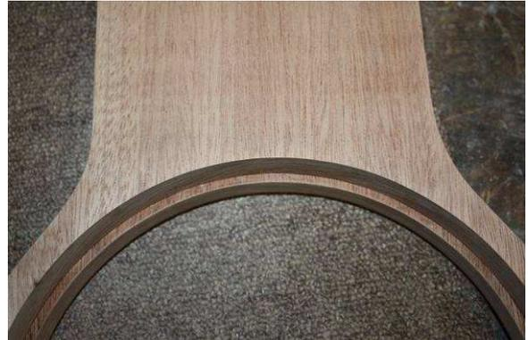
Découpe de deux panneaux, le premier ( en BC de 5 mm ) qui sert de support pour le mécanisme de la montre et sur lequel on mettra de l'autocollant noir mat , et le deuxième ( BC de 1,5 mm ) qui va être chantourné avec un logo
