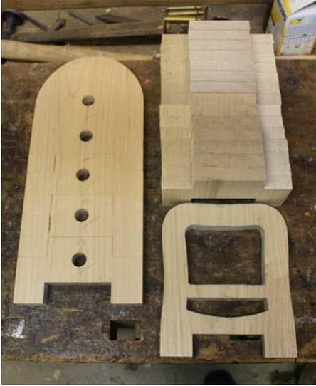
Il ne reste plus qu'à casser les angles avec une fraise quart de rond montée sur la défonceuse, un roulement fait office de guide.
