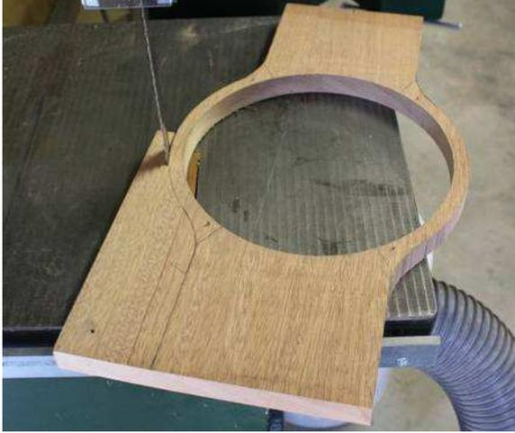
Pour que le boîtier s'accorde avec les maillons, un petit travail à la main s'impose, ramener les bouts du boîtier à l'épaisseur des maillons.
