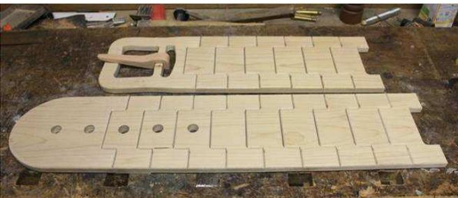
Première découpe à la défonceuse, le cadran du boîtier. (diam ext. 280 mm et largeur 18 mm)
