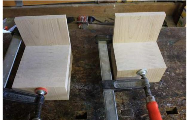
L'entaille dans le maillon est réalisée à la circulaire selon la méthode du bloc : dimension de l'entaille 80 mm X 25 mm
