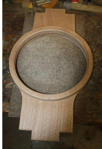
Sur cette photo on voit la différence de diamètre entre le cadran et le boîtier, ça fait office de battue pour mettre le panneau support du mécanisme.
