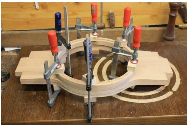
Le boîtier est collé et pré-poncé avant le montage.
