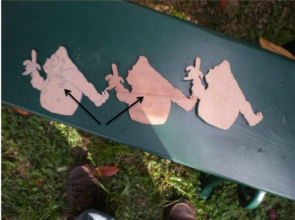
Une des jambes étant amovible, il faut évider partiellement le CP de 10mm. Il est nécessaire que la jambe fixe soit devant. La jambe mobile sera fixée au centre de gravité (on verra plus bas qu'il faudra l'ajuster un peu)
