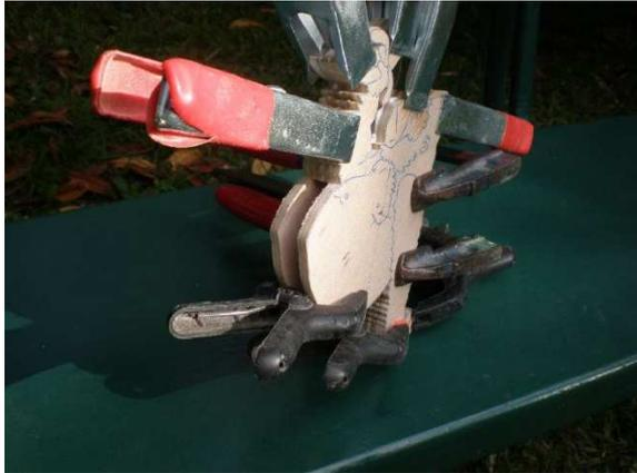
Après séchage, il faut légèrement rectifier le centre de gravité G et le déplacer à gauche (vers la future jambe fixe) de 9/10mm et 2mm plus bas, comme sur cette photo en G1 . A défaut, le jouet ne basculera pas.
