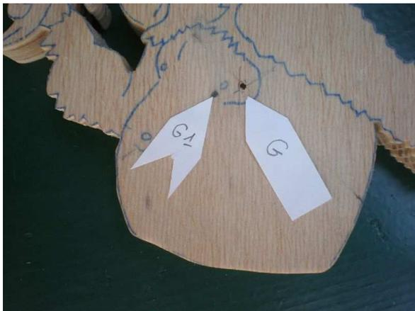
On peut coller la jambe fixe et percer G1 de part en part à 4mm. Bien aligner les deux pieds, marquer à la hauteur de G1 l'emplacement où la jambe mobile doit être percée à son jour (trou de 4,5mm pour un bon pivotement). L'écartement maximum entre les deux pieds doit être de 15/18mm
