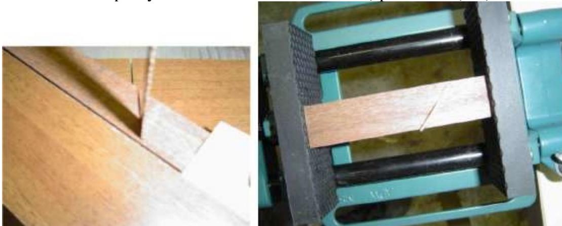
5) Poncer proprement l'insert, tourner le carrelet de 90° pour effectuer la 2<sup>ème</sup> coupe
