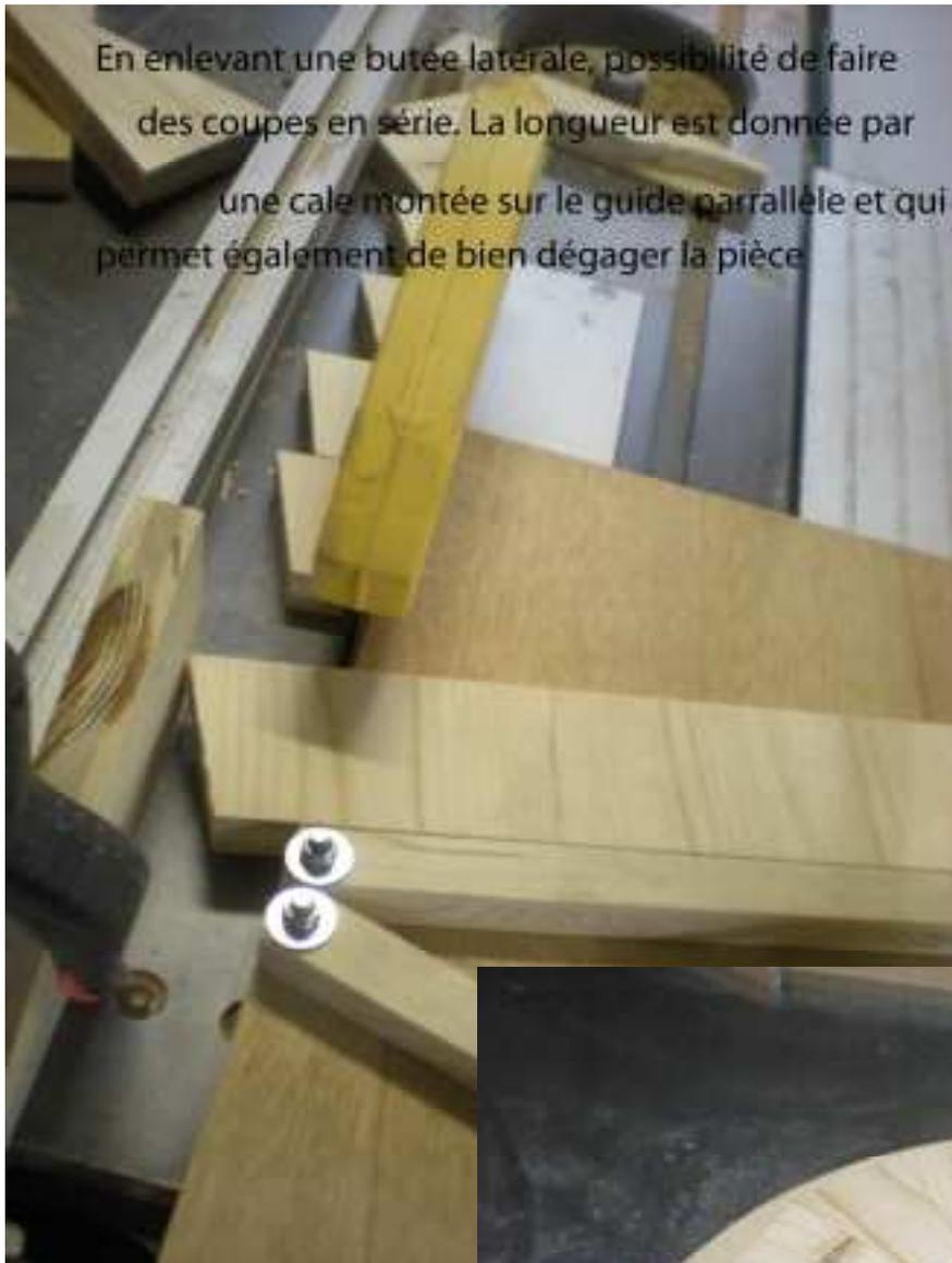
Des coupes en série pour le tournage segmenté par exemple.
