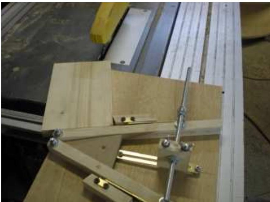
Ci contre, réalisation de la première coupe. Le gabarit de réglage a été laissé en place pour facilité la compréhension, mais il est préférable de le retirer par sécurité. La buté latérale est serrée, la coupe sera très exactement sur le bord de l'embase.
