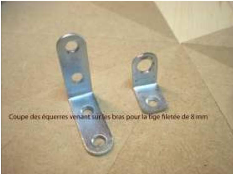
Deux équerres de chaise sont recoupées et reperçées à 8 mm d'un seul côté. C'est le passage de la tige filetée servant au réglage des bras.
