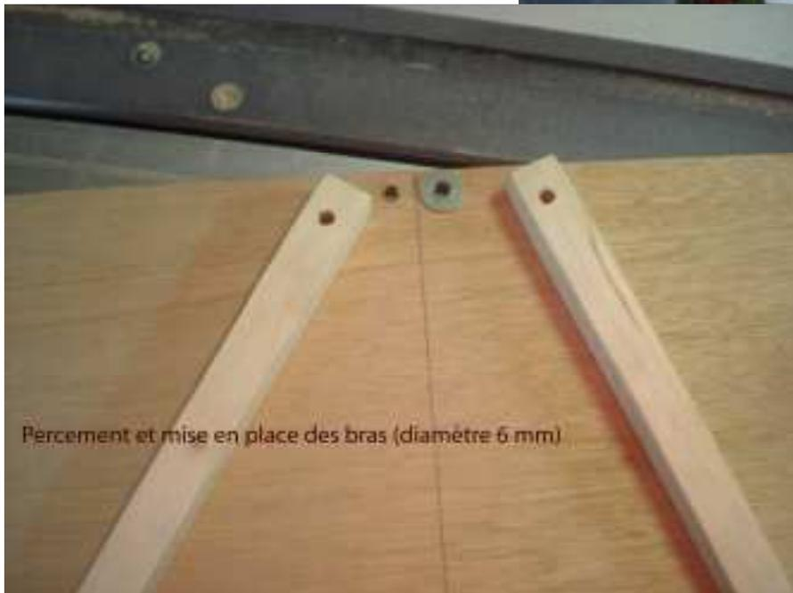
La rondelle détermine l'axe de rotation des bras et elle affleure le bord du socle
