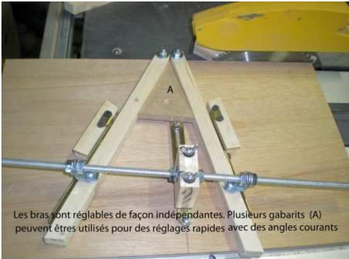
du coulisseau central sont utilisés pour régler finement l'angle de coupe choisi. Sur la photo ci-dessus, l'angle de coupe du bras situé à droite sera parfaitement complémentaire de l'angle de coupe du bras gauche.
