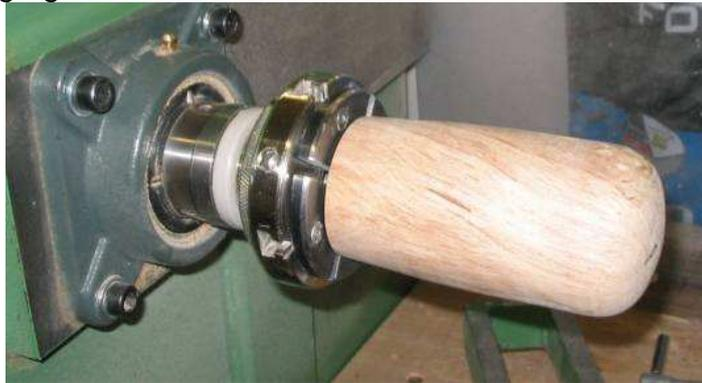
Creusage du corps : A l'extrême limite, on pourrait même se passer d'un creusage "façon tourneur". Le seul recours à quelques mèches Forstner peut suffire : à la base du corps : Ø 50 sur environ 20mm de profondeur.
