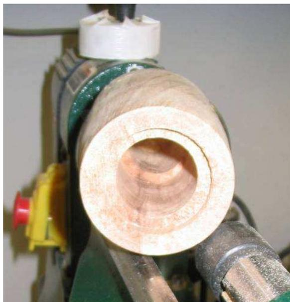
Dans ce cas, le trou du cou au  $\varnothing 20$  est percé selon un angle d'environ  $100^\circ$ , en plongée ( je n'ai rien vérifié, je procède au pif : je tiens le corps de la main gauche et je perce à la volée en visant le du centre du corps. C'est un peu scabreux et on peut certainement trouver une façon plus prudente de procéder en maintenant la pièce dans un étau ? ...)
