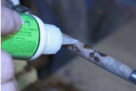
Application de CA épaisse pour Un 2 ème masticage des défauts
