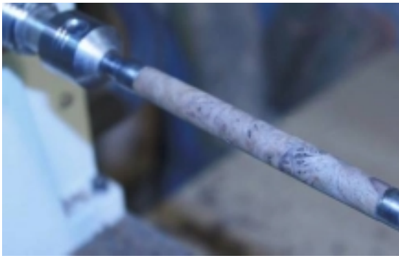
Application de CA épaisse pour Un 2 ème masticage des défauts
