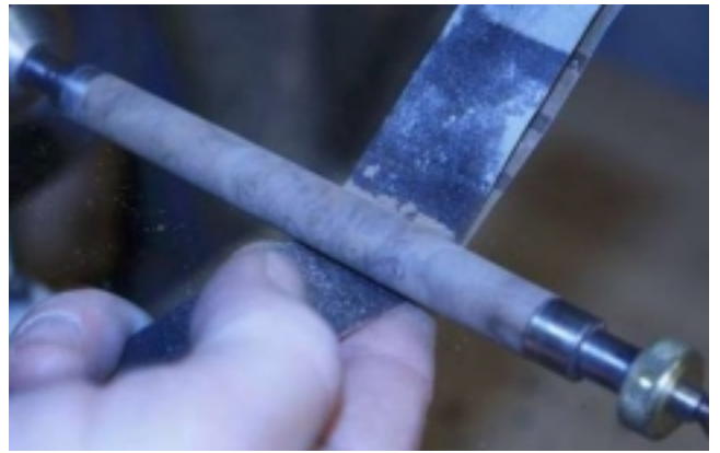
Et surtout pour chaque opération de ponçage Il faut poncer dans le sens des fibres
