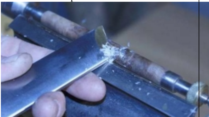
Nettoyage du cylindre à l'aide de la plane Il faut enlever le surplus de CA
