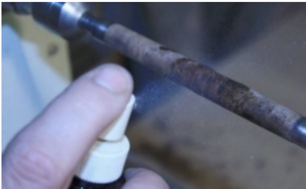
Nettoyage du cylindre à l'aide de la plane Il faut enlever le surplus de CA
