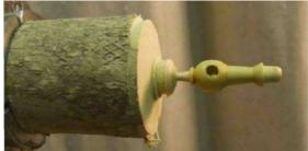
Tourner l'axe avec une rondelle d'ornementation + la boule percée sur le coté afin d'y fixer la partie horizontale de la manivelle ... percée elle aussi à l'extrémité pour recevoir la partie verticale.
