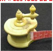
Tourner un cylindre de buis de 58mm de diamètre long de 34mm + épaisseur de coupe selon le bédane, soit environ 7mm jusqu'à atteindre le fond.
