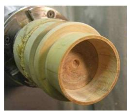
Creuser en laissant la paroi a 3 ou 4 mm ensuite, à nouveau un cylindre pour la base diam 58 épais 7mm.
