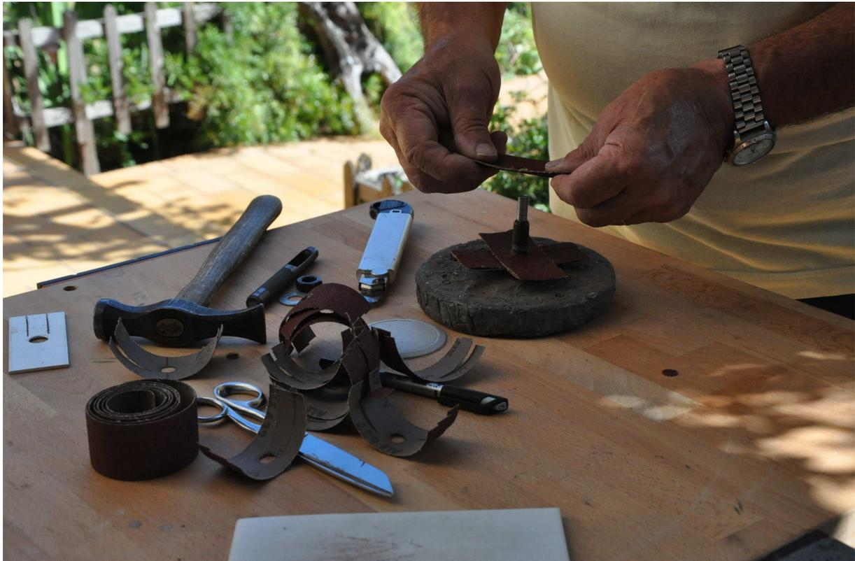
après avoir bien serré les bandelettes entre les écrous sur la tige votre outil est prêt à l'utilisation en vitesse moyenne 1000 à 1200 tours sur une perceuse le résultat est parfait et pas trop agressif pour le bout des doigts
