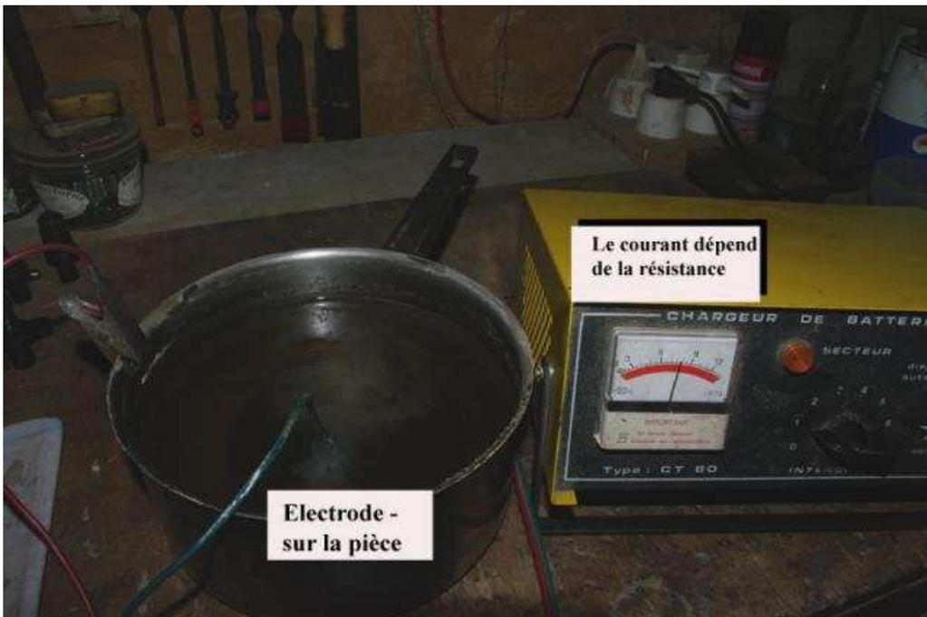
Pour les petites pièces, avantage de l'inox : la cuve (reliée au +) n'est pas attaquée et le bain reste propre
