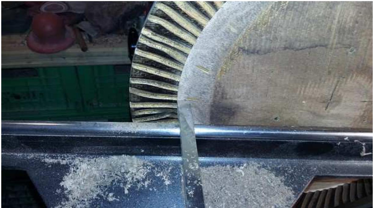
Vient à présent la phase de creusage traditionnel vers la forme voulue, ensuite le ponçage et gommage des défauts de tournage et c'est maintenant qu'intervient la finition à la "carnaubaixas" à chaud, le bâton de cire d'une main le pistolet thermique de l'autre. Le tour en rotation à "DONF", je fais pénétrer la cire ensuite toujours en rotation, l'étalage au pinceau, et ensuite la frotte au chiffon soyeux et en dernier le frottage à la brosse de sanglier .
