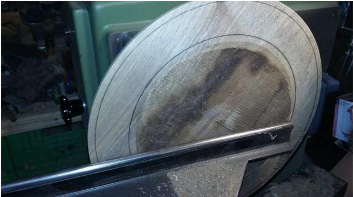
Pour la phase à suivre et par précaution, dans la mesure du possible, vous raidissez la rotation du plateau ( perso je glisse un morceau de bois avec une éponge sur le banc du tour ), je règle la hauteur du porte outil un peu en dessous de l'axe et assez en retrait pour ne pas accrocher avec ma râpe en rotation, je vais travailler à l'horizontale du trait intérieur vers le trait extérieur en ayant le plus possible la pénétration régulière.
