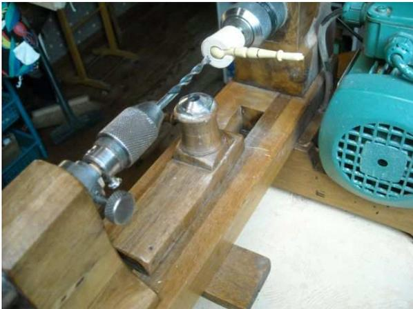
Perçage d'un avant trou avec un foret.
