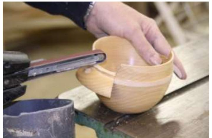
On termine la découpe à l'aide d'une lime électrique et d'une lime à mains.
