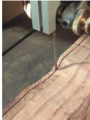
Primo (Carnera) : toujours commencer par prélever la tranche qui constituera le fond de la boîte ( 8mm d'épaisseur environ). Je ne trusquine pas, j'utilise simplement le doigt plié et je trace au pifomillimètre. Si le trait de scie ne suit pas parfaitement la ligne tracée, ce n'est pas mortel non plus.
