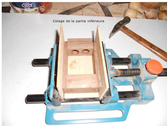
Figure 4 et 5 - Collage des deux parties. (la photo de droite montre une possibilité de collage avec l'alignement des deux parties)
