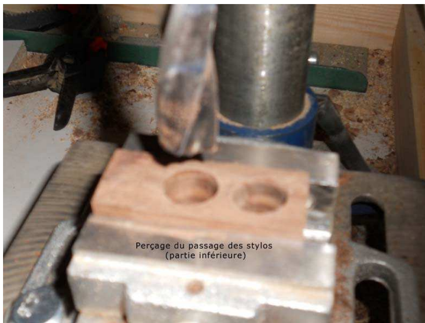
Figure 2 - Perçage du passage du stylo/porte-mine (élément intermédiaire)
