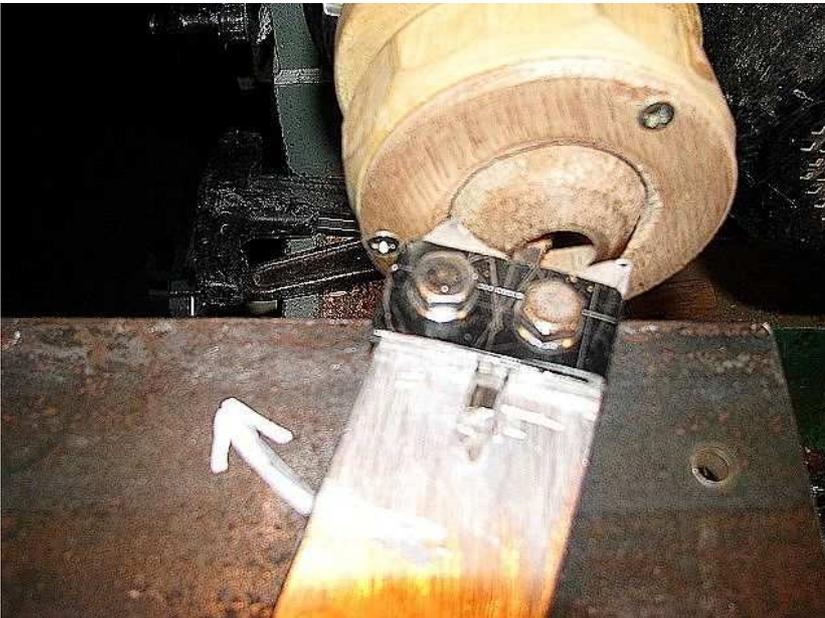
On tourne le porte couteau vers la gauche lentement (flèche) jusqu'à venir en butée contre la partie gauche, on ressort en dégageant l'outil vers la droite lentement
