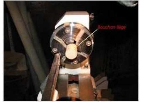
Tournage d'un bouchon en liège
