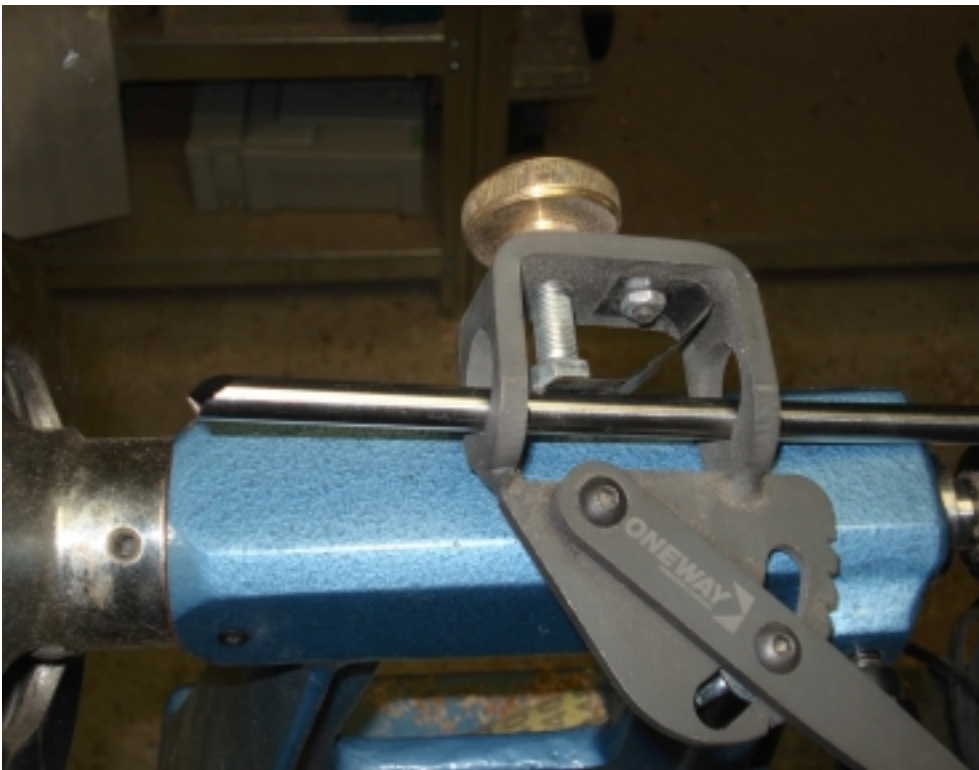
Réglage modifié, je suis en position 1 l'outil dépasse de 65 mm et je règle à 45°
