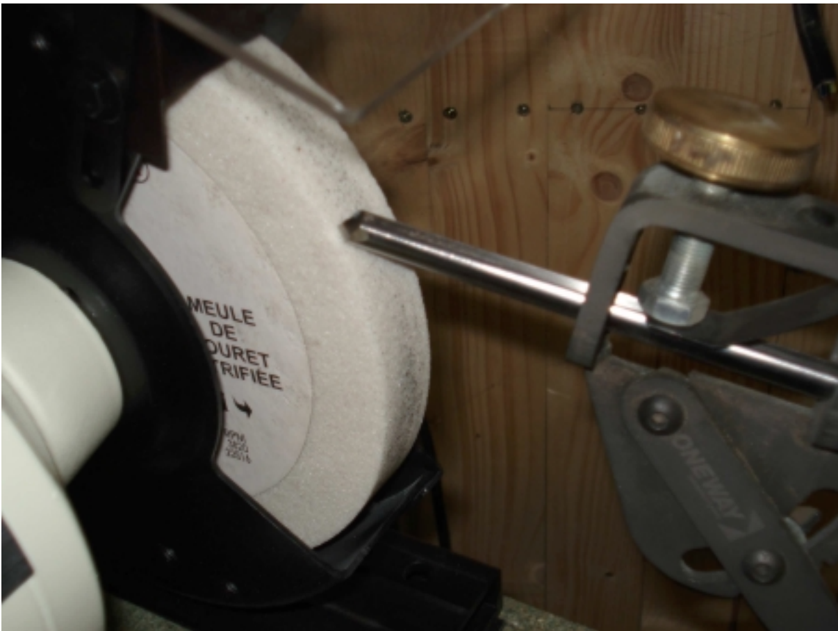
Présentation sur le touret, réglage à 45°, gouge dépasse de 65 mm.
