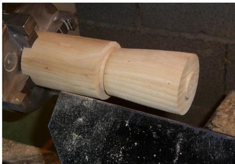
16- Monter un cylindre de bois dur sur le mandrin et profiler l'extérieur du gobelet
