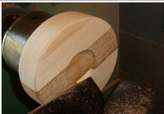
3- Cylindrer le disque et dresser la base en réalisant une empreinte pour prise sur mandrin en extension
