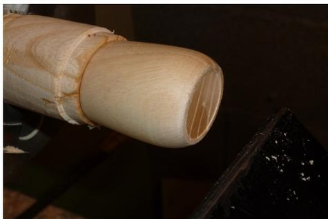
23- Sur le cylindre restant, réaliser une empreinte au diamètre interne du toupillou (ajustement serré).
