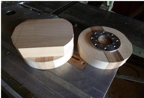
1- Ébaucher 2 disques d'environ 200mm de diamètre dans un bois assez dur. Un disque fait 45mm d'épaisseur et l'autre le double. Pour ma part j'ai pris du merisier et (je crois) du noyer. N'ayant pas de plateau d'épaisseur suffisante j'ai obtenu ces disques par collage.
