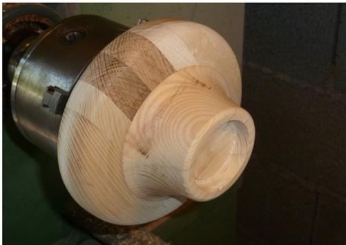
13- Retourner la pièce et la monter en prise en extension dans le logement du gobelet.
