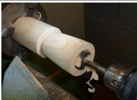
17- Aléser le gobelet à l'aide d'une mèche à bouchonner montée sur mandrin sur la poupée mobile.
