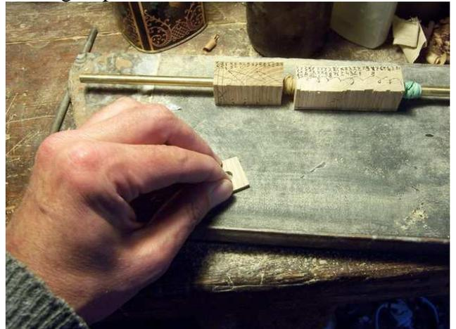
Les pièces sont collées en spirale autour d'un tube à stylo en alignant le repère sur le bord de la pièce précédente. En haut de la photo, une partie du stylo est déjà collée, on voit le repère vers le côté droit. En bas, l'autre partie du stylo pendant le collage :
