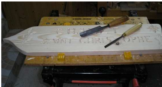
16) Cassage des arêtes à la gouge afin de faire plus "rustique"
