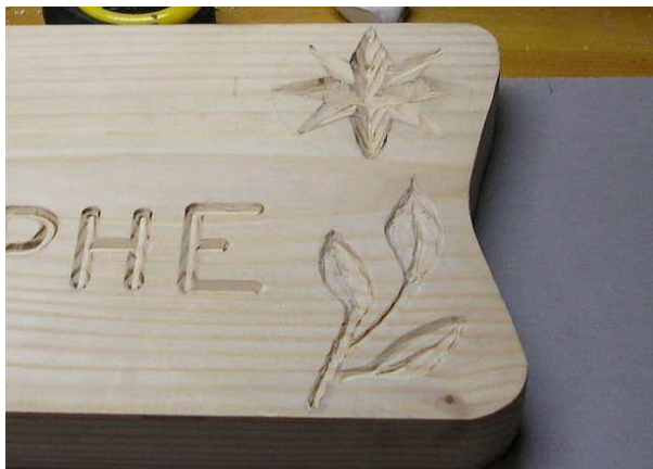
16) Cassage des arêtes à la gouge afin de faire plus "rustique"
