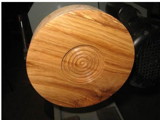
3) Réaliser la finition sur le dessous de la pièce.
