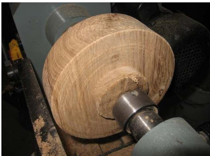
1) Cylindrez un disque et réalisez un tenon pour la reprise en mandrin.
