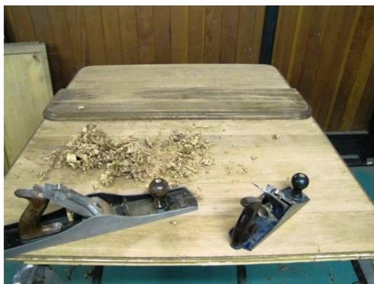
En rabotant le dessus de la table une petite casse est survenue, peut être une fragilisation lors à la mise à la benne, pas grave il ne me reste plus qu'à la recoller, et continuer le rabotage.
