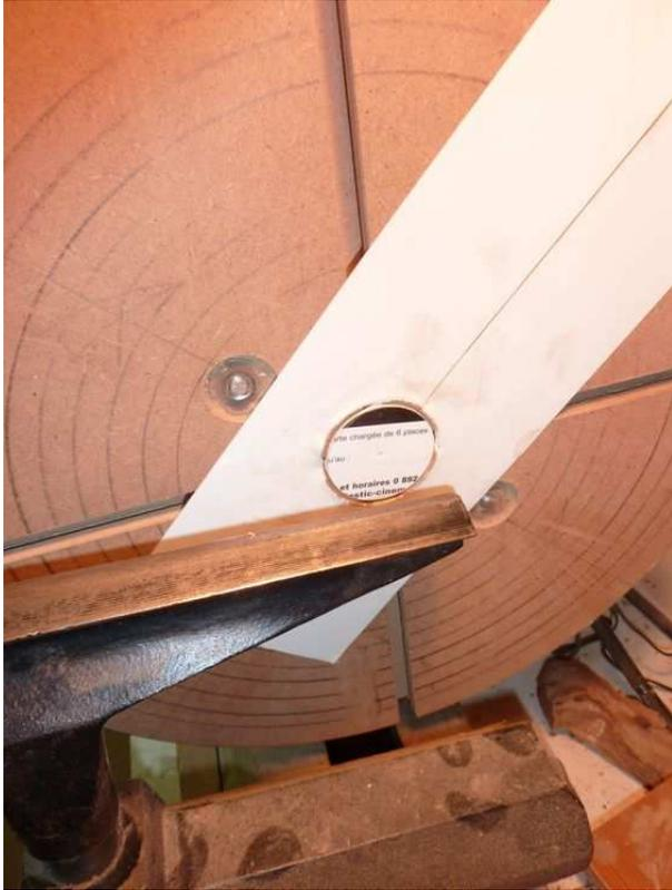
Positionner la première moitié, sur le même disque en la centrant avec la contre pointe.
