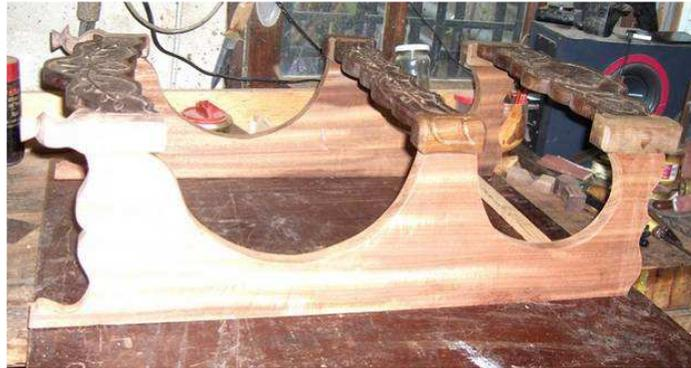
Même procédure pour les extrémités des traverses médianes et supérieures. Assemblage des traverses sur les cotés (par tourillons).
