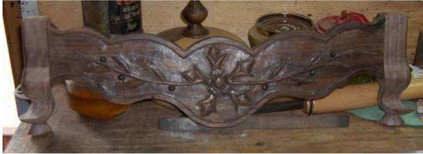
Après traçage, ils sont dégrossis à la scie à ruban, finis à la rape, papier abrasif et racloir ; puis assemblage par tourillons sur la traverse basse.
