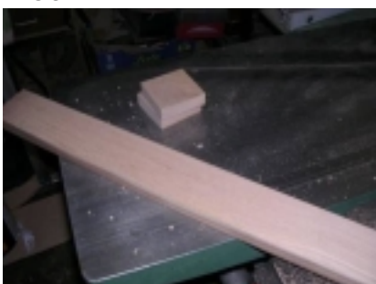
Puis leur faire faire un quart de tour et les coller ensemble , Raboter une planchette de 60 x 600 en 15 d'épaisseur puis la découper en 9 carrés de 60 x 60
