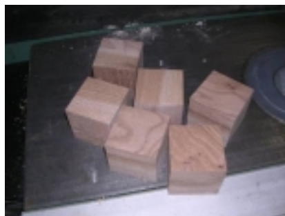
Puis leur faire faire un quart de tour et les coller ensemble , Raboter une planchette de 60 x 600 en 15 d'épaisseur puis la découper en 9 carrés de 60 x 60
