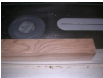
Puis leur faire faire un quart de tour et les coller ensemble , Raboter une planchette de 60 x 600 en 15 d'épaisseur puis la découper en 9 carrés de 60 x 60
