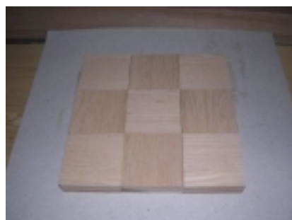
Puis leur faire faire un quart de tour et les coller ensemble , Raboter une planchette de 60 x 600 en 15 d'épaisseur puis la découper en 9 carrés de 60 x 60
