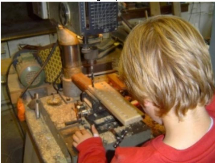
Ensuite tronçonnage de 24 tiges de 10 mm de diamètre
