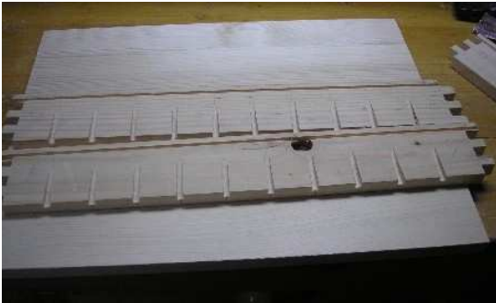
26) Sciage des séparations (Contre-plaqué), arrondies pour pouvoir bien rentrer, et mise en place
