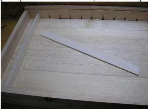
26) Sciage des séparations (Contre-plaqué), arrondies pour pouvoir bien rentrer, et mise en place
