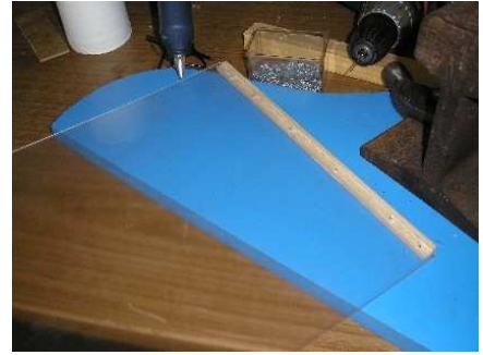
28) Assemblage de la chute sur le plexi, un peu raté, cela ne tenait pas à la colle, j'ai cloué avec de petits clous, mais cela a un peu fissuré le plexi malgré des avant trous ..
