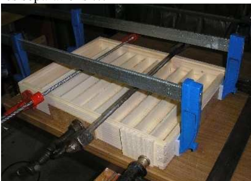
27) Collage de l'ensemble, attention à ne pas oublier les séparations ...
